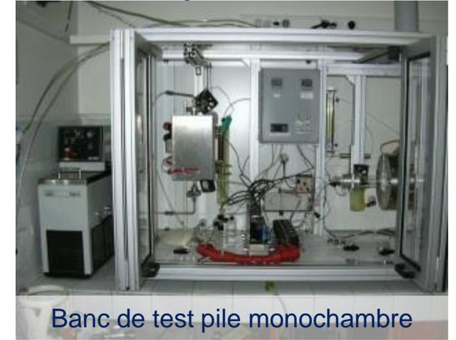
Banc de test pile monochambre
